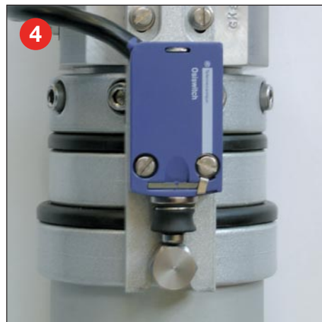
Standard angebauter und verkabelter Mastausfahrwarnschalter
